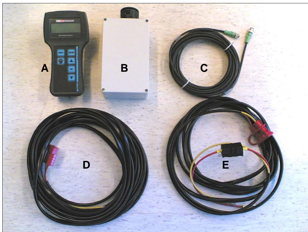
Kuva 1: Automatiikkalaitteiston osat (kuvan käyttölaite A on ilman ajouramerkkaimen ohjausta)
