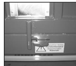
Hydrauliskt baklämslås i öppet läge på släpvagnen
