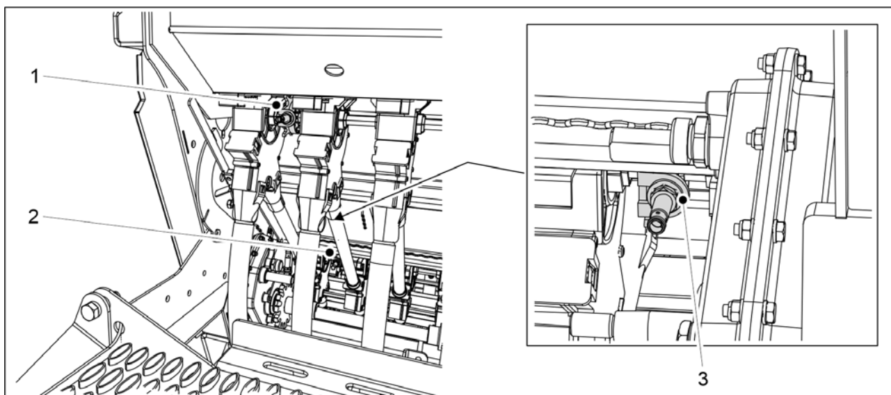
Bild. 4.1.1.5 - 21. Placering av en drivaxelns rotationsvakter
