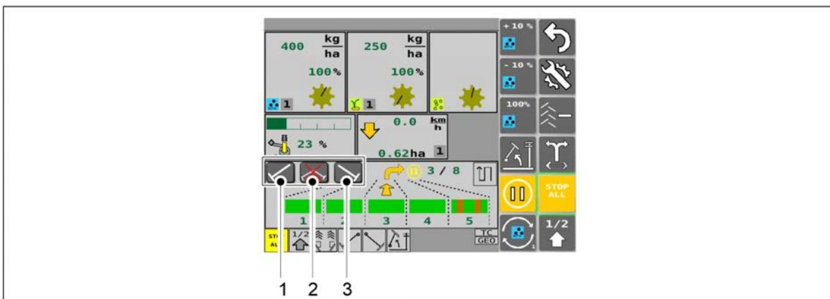
Bild. 6.3.7 - 152. Manuell kontroll och påtvingad åtgärd för mittmarkörer
