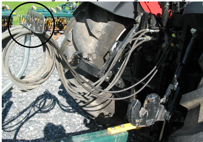
Bild 2. Justering av hydraulslangarnas längd
