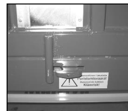
Hydraulisk lås for bakluken i åpen stilling i tilhengeren
