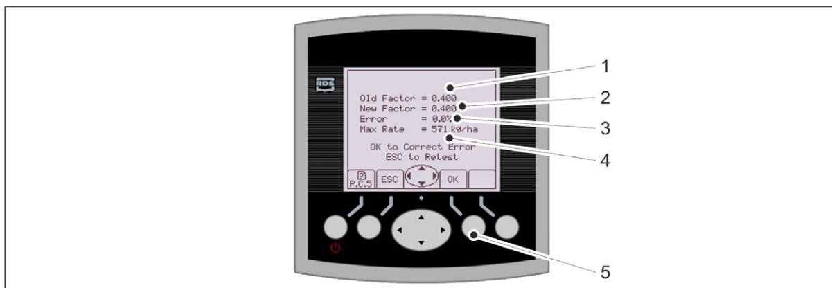
Attēls. 6.8.4. - 129. Kalibrēšanas pārbaudes kalibrēšanas vērtības — mašīna ar pārnesumkārbu
