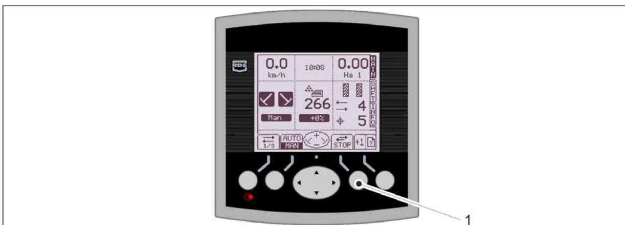
Paveikslėlis. 6.3.3.2 - 120. Technologinės vėžės skaitiklio užlaikymas
