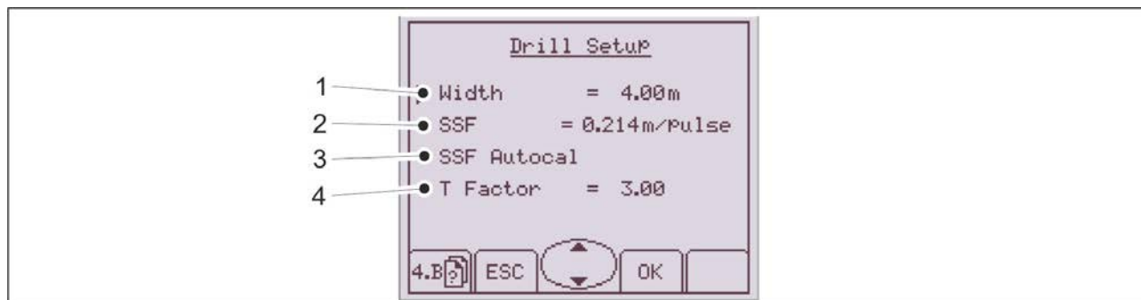
Paveikslėlis. 4.1.4.3 - 33. Sėjamosios parametrai
