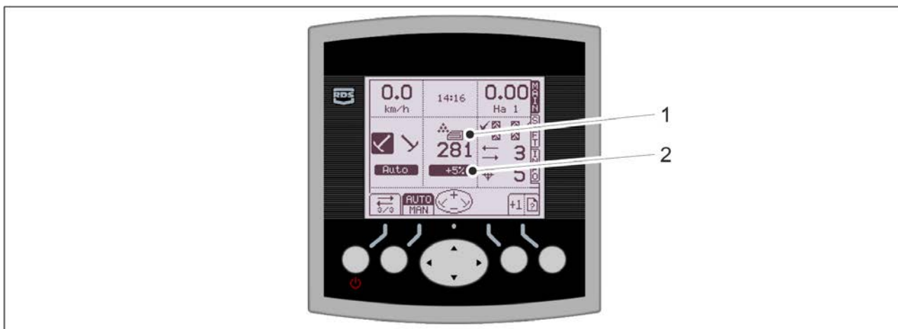
Paveikslėlis. 6.3.5 - 123. Trašų tikslinės normos reguliavimo keitimas
