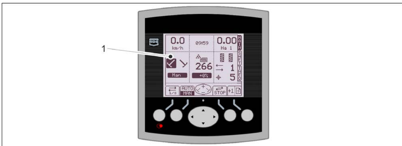
Paveikslėlis. 6.3.2.2 - 118. Vidurinių ženklintuvų pasirinkimas
