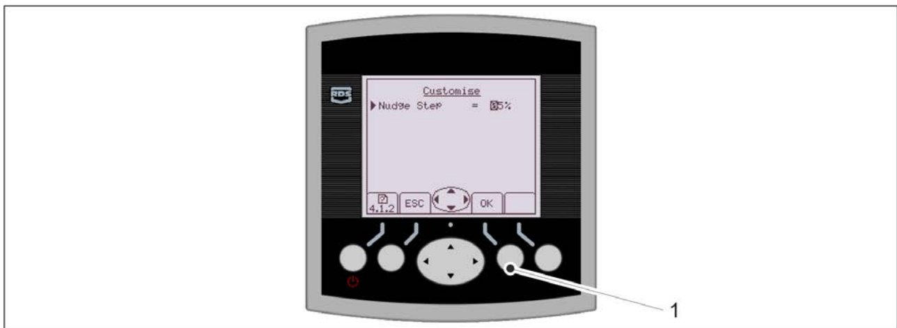
Paveikslėlis. 4.1.4.2 - 32. Trašų tikslinės normos žingsnio reguliavimas
