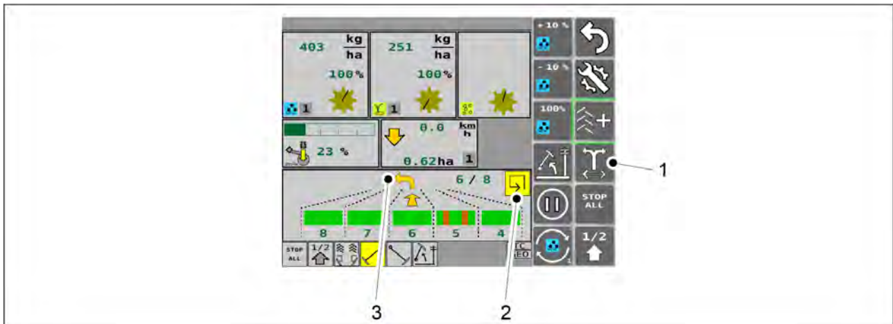
Ábra. 6.3.6 - 150. A középnyomjelző automatizálása
