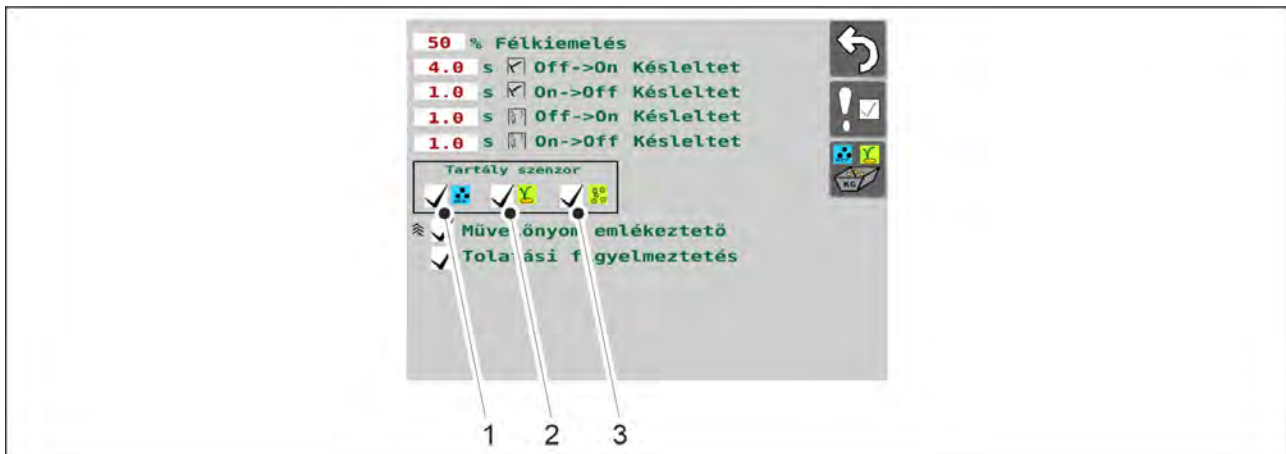
Ábra. 6.3.9 - 154. A tartálysint-érzékelők kiválasztása
