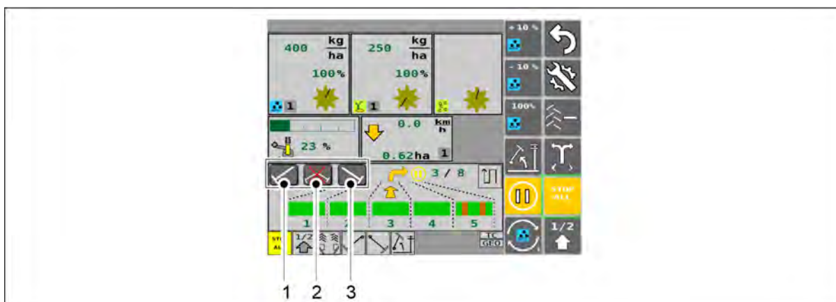
Ábra. 6.3.7 - 152. A középnyomjelzők kézi vezérlése és kényszerű bekapcsolása
