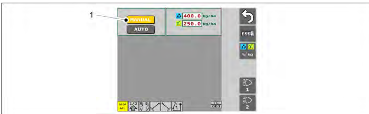
Ábra. 6.3.11 - 157. A kézi üzemmód kiválasztása
