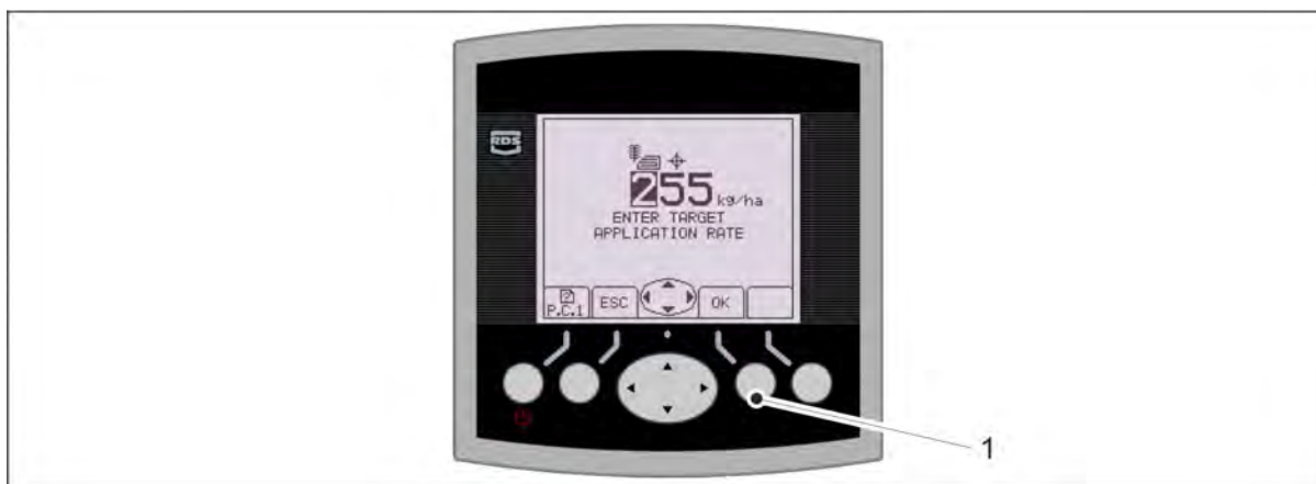
Ábra. 6.8.4 - 180. A műtrágya célmennyiségének beállítása
