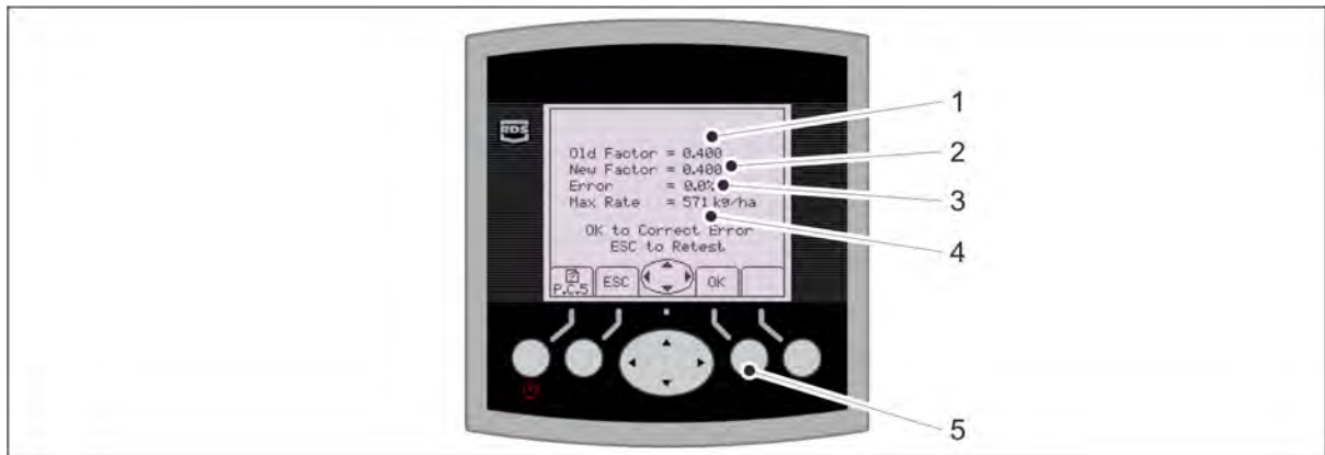
Ábra. 6.8.4 - 184. A kalibrációs teszt kalibrációs értékei
