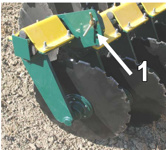
3. ábra A szintezőtarcsa beállítása
