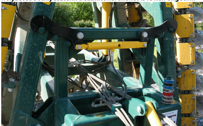
1. ábra A szárnyszelvények reteszelő szerkezete
