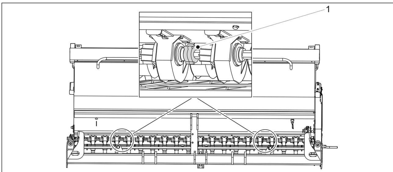
**Figure. 4.2.1.6. - 19. Tramline clutches**
