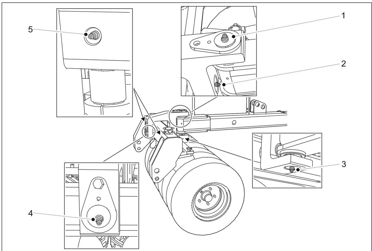
**Figure. 7.2.10. - 206. Wheel packer pins**
