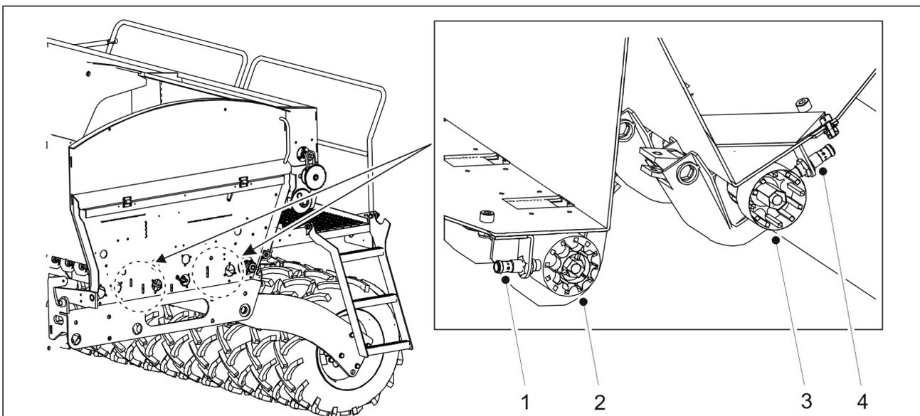
**Figure. 4.2.1.4. - 17. Shaft rotation guards**
