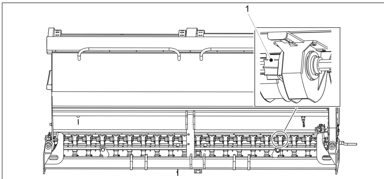
**Figure. 7.3.5. - 217. Feeder roller**
