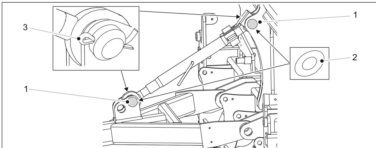
Figure. 5.1.3. - 56. Turnbuckle
