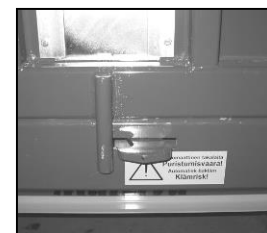
Hydraulisk låseanordning til bagklap I åben position i traileren
