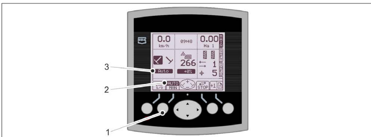
Obrázek. 6.3.2.1 - 114. Volba automatického a manuálního režimu pro střední značkovače
