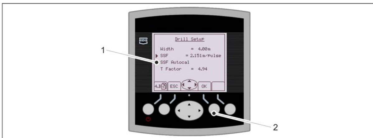
Obrázek. 7.10.2 - 315. Úvodní obrazovka kalibrace na uživatelském rozhraní
