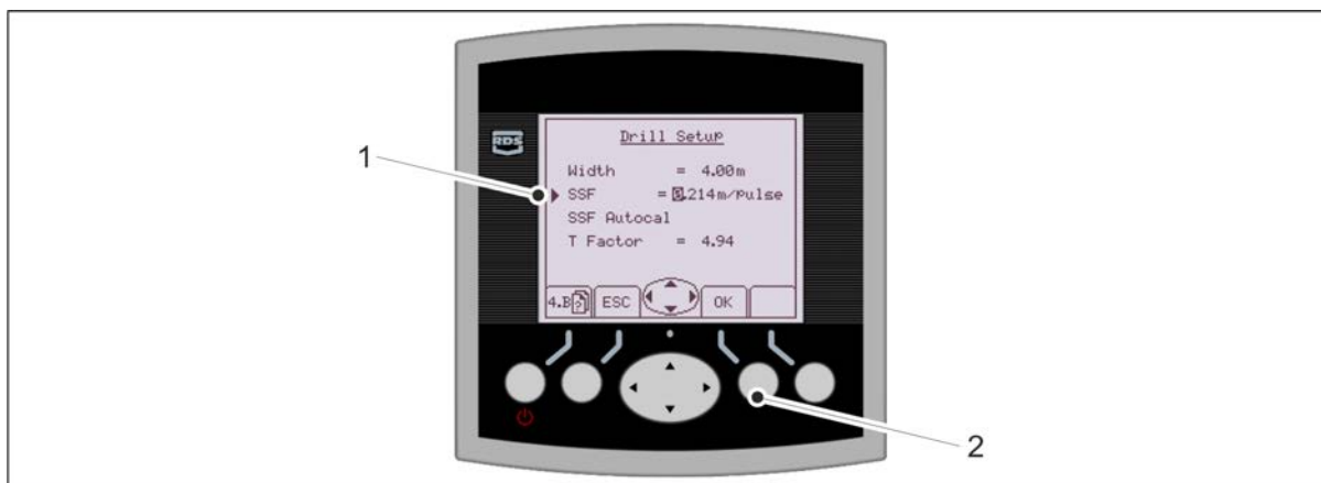
Obrázek. 7.10.1 - 314. Úvodní obrazovka kalibrace na uživatelském rozhraní
