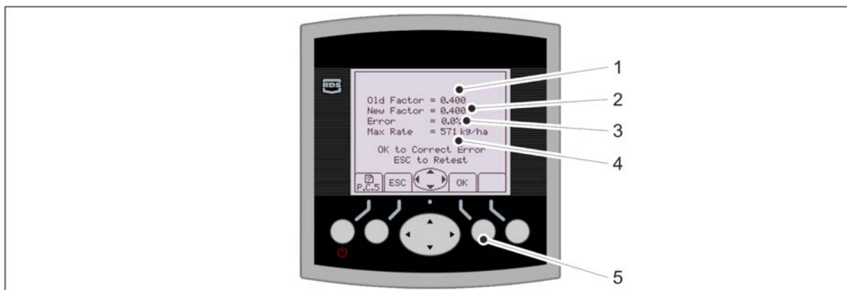
Obrázek. 6.8.4 - 181. Kalibrační hodnoty pro kalibrační zkoušku
