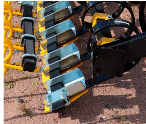
Stabilizátor rúd hátsó simítóhoz
